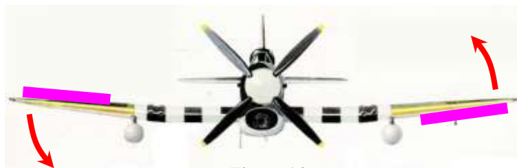
Figure 14 : braquage différentiel des ailerons sur Hawker Tempest.
