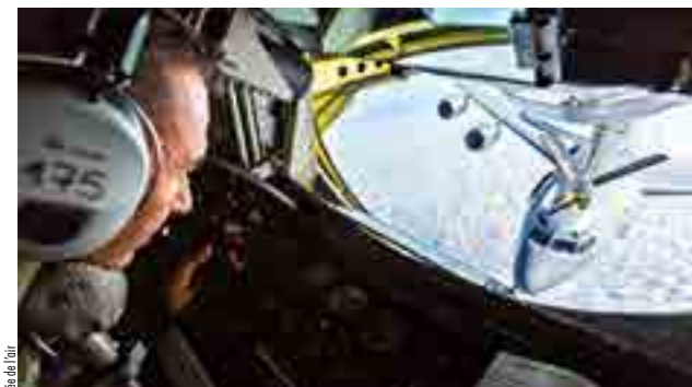
L'opérateur de ravitaillement dirige la perche rigide du C-135 à l'aide de manettes de commande.
